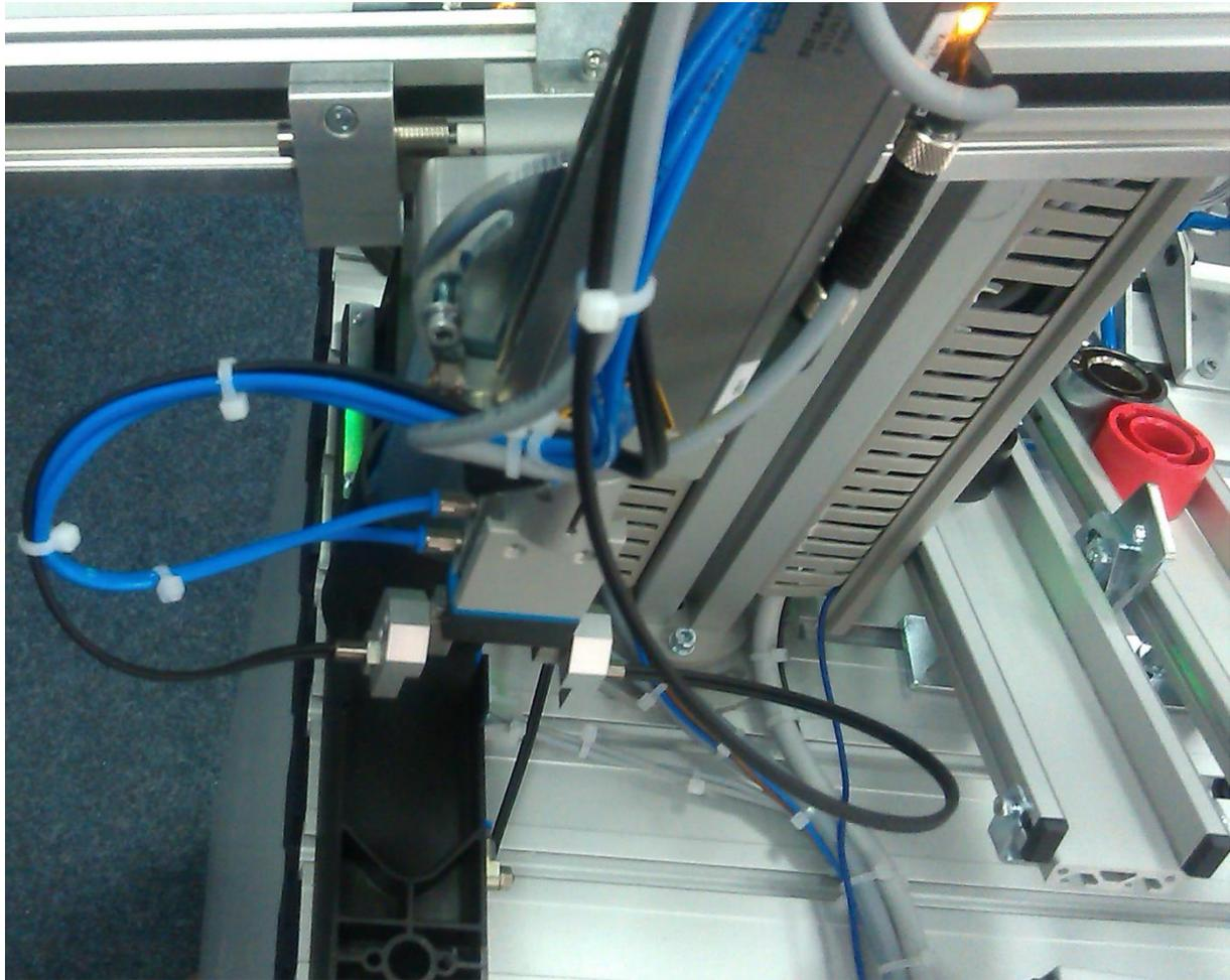
В захват монтируется оптоволоконно двух диффузионных датчиков: «наличие детали» и «деталь не черная». Захват необходимо расположить на штоке ПЦ так, как показано на рисунке. Корпус датчика наличия детали расположен на плате станции. Корпус датчика «деталь не черная» расположен на задней стороне вертикальной стойки.
